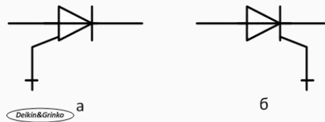
Рис. 5.14. Условные обозначения запираемых тринисторов: а - с управлением по аноду; б - с управлением по катоду
