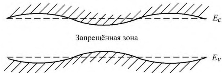
Рис. 4.5 – Изменение ширины запрещенной зоны под действием продольной акустической волны
