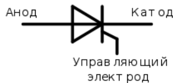
Рисунок 5.2 – Обозначение тринистора на схемах
