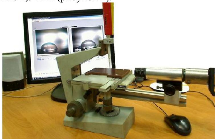
Рисунок 2 – Установка для измерения краевого угла смачивания «Капля-2»
