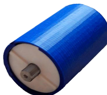
Рисунок 3 – Прототип ролика ленточного конвейера
