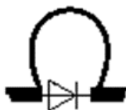
Рисунок 4 – Схема шунтирования полупроводникового элемента
