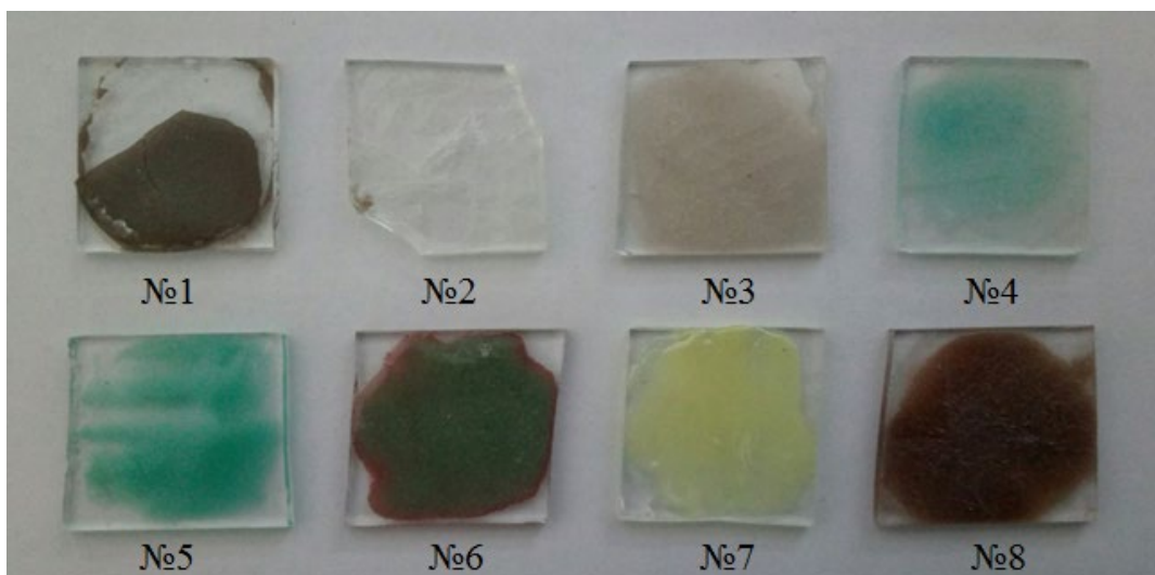
Рисунок 1 – Внешний вид образцов легкоплавких стеклокомпозиций составов №1-8
