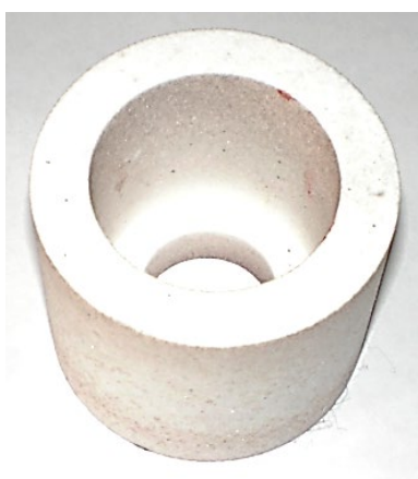
Рисунок 3 – Экспериментальный шлифовальный круг 60*50*25
