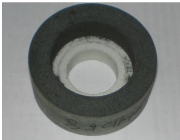
Рисунок 1 – Круг «3NQ120K8VS3» фирмы «Нортон»
