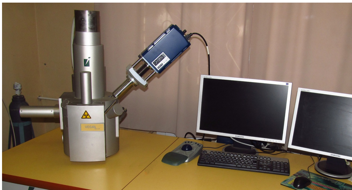
Рисунок 2 – Сканирующий электронный микроскоп VEGA II LSH
