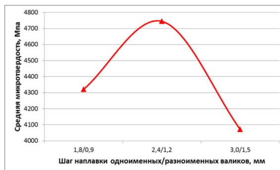
Рисунок 7 – Зависимость средней микротвердости фазы бронзы ПГ-19М-01 от шага наплавки одноименных/разноименных валиков
