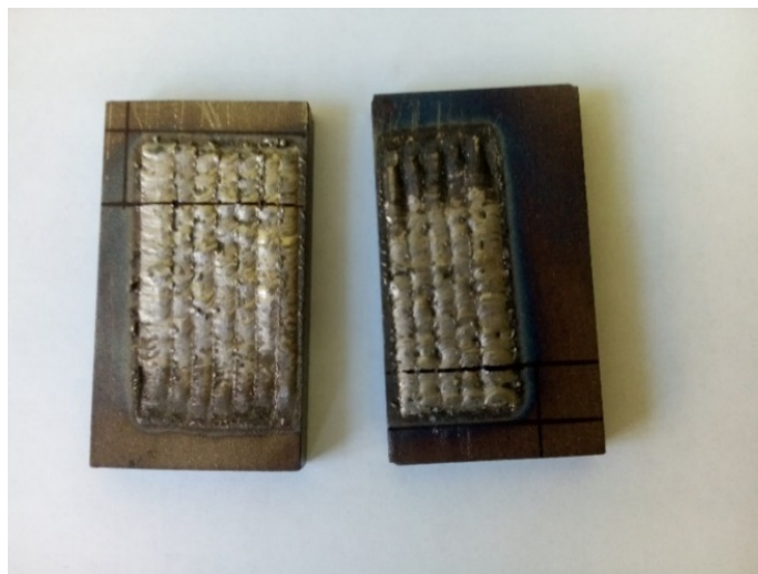
Рисунок 2 – Образцы наплавленного покрытия
