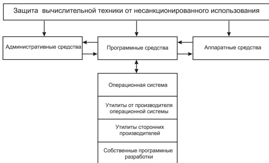
Рисунок 2 – Защита вычислительной системы от несанкционированного использования
