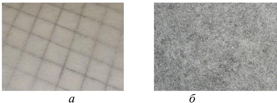
Рисунок 4 – Оптические изображения участков образцов волокнистых РПМ, армированных углеродными нитями (*а*) и углеродной тканью Бусофит ТР 3/2 (*б*) (масштаб 2:1)
