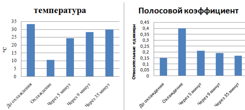
Рисунок 3 – Изменение полосового коэффициента и температуры при холодном воздействии
