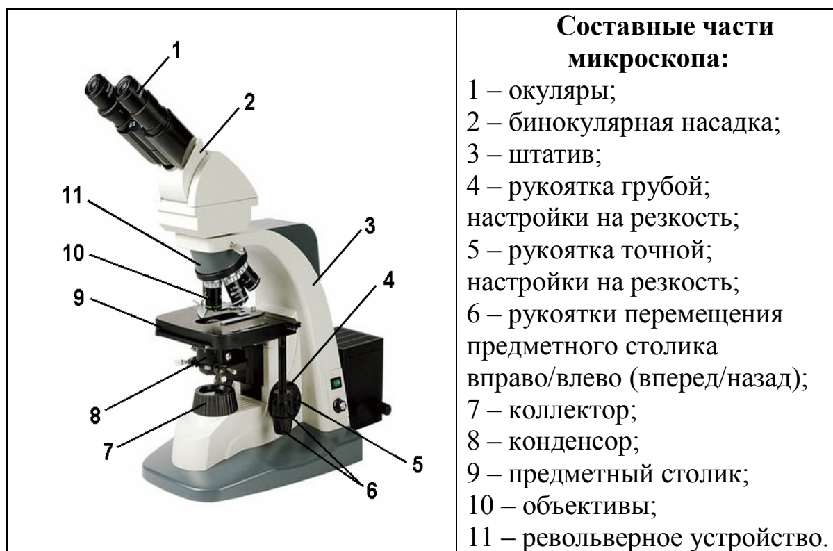
Рисунок 3.1 – Устройство и внешний вид микроскопа
