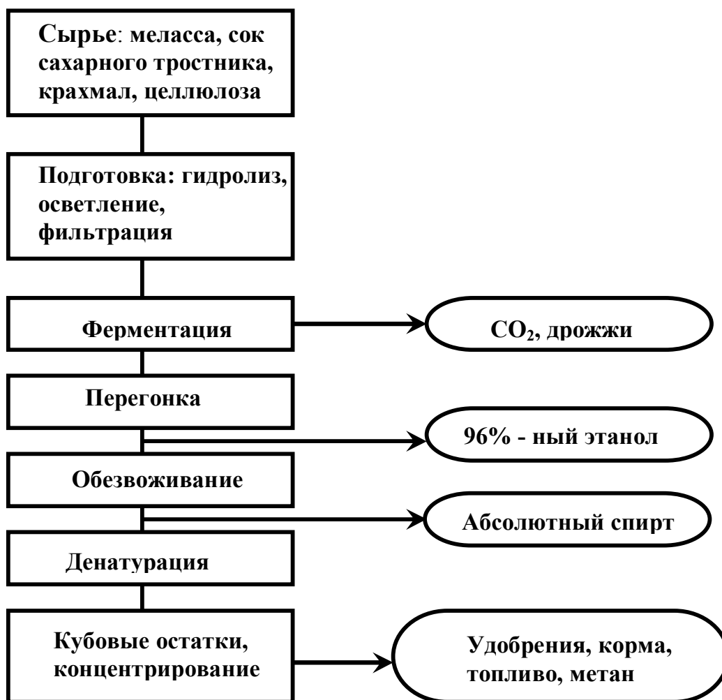
Рис. 6. Схема производства этанола
