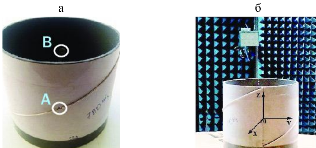
Рисунок 2 – Экспериментальный образец бифилярной антенны: а) бифилярная спираль с каркасом (А и В – точки запитывания фидерной линии); б) расположение антенны относительно рупорного приемника
