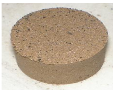
Рисунок 1 – Спрессованные образцы керамической массы
