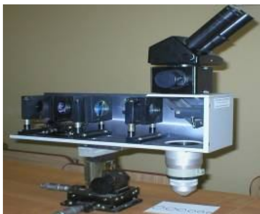
Рисунок 3 – Оптическая приставка для формирования пучков кольцевого сечения
